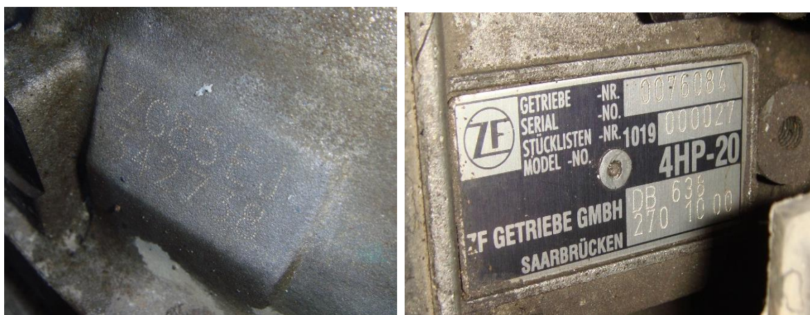
Иллюстрация 1,2. Внешний вид способов маркирования АКПП легковых автомобилей
