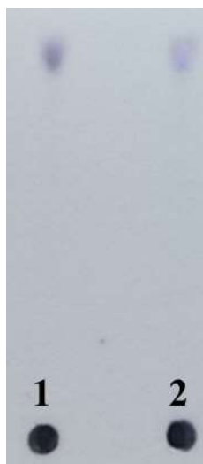
Рисунок 1 – Хроматограмма тонера Samsung 3140: 1 – в виде порошка, 2 – с бумажного носителя
